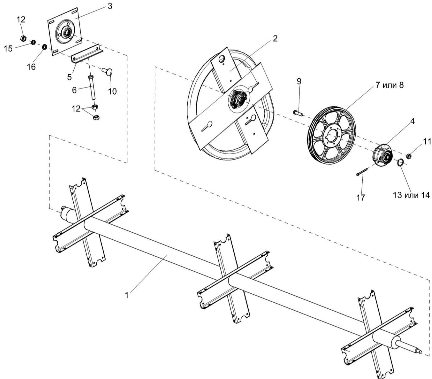
Рисунок 12 – Мотовило (установка дорожки, плиты с подшипником, муфты обгонной)
