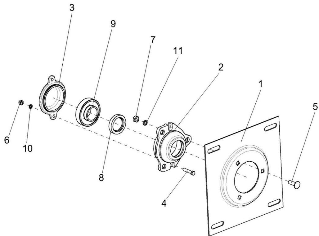
Рисунок 16 – Плита с подшипником КИС 0203050Б
