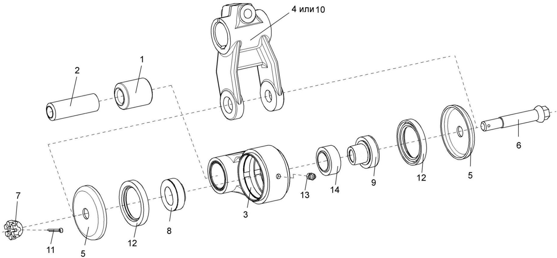
Рисунок 20 – Привод ножа КИС 0216020В
