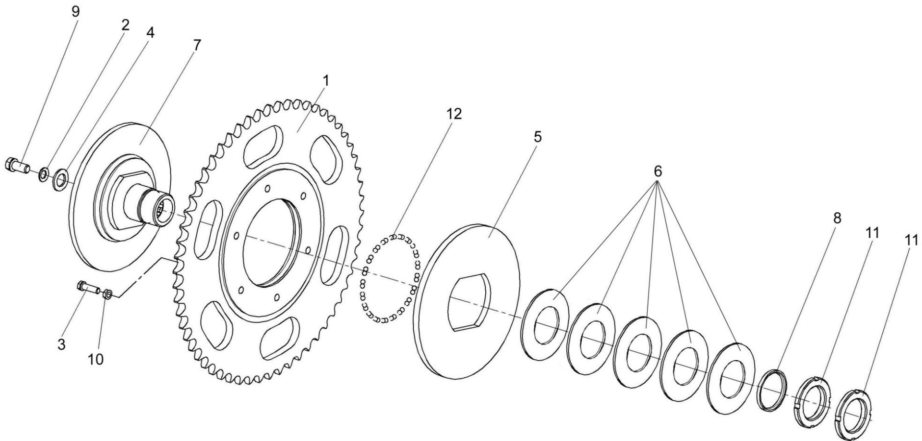
Рисунок 4 – Муфта фрикционная КИС 0202090А-01
