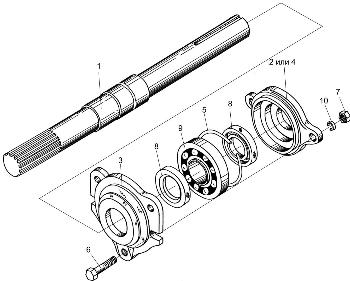
Рисунок 7 – Контрпривод ПКК 0464000
