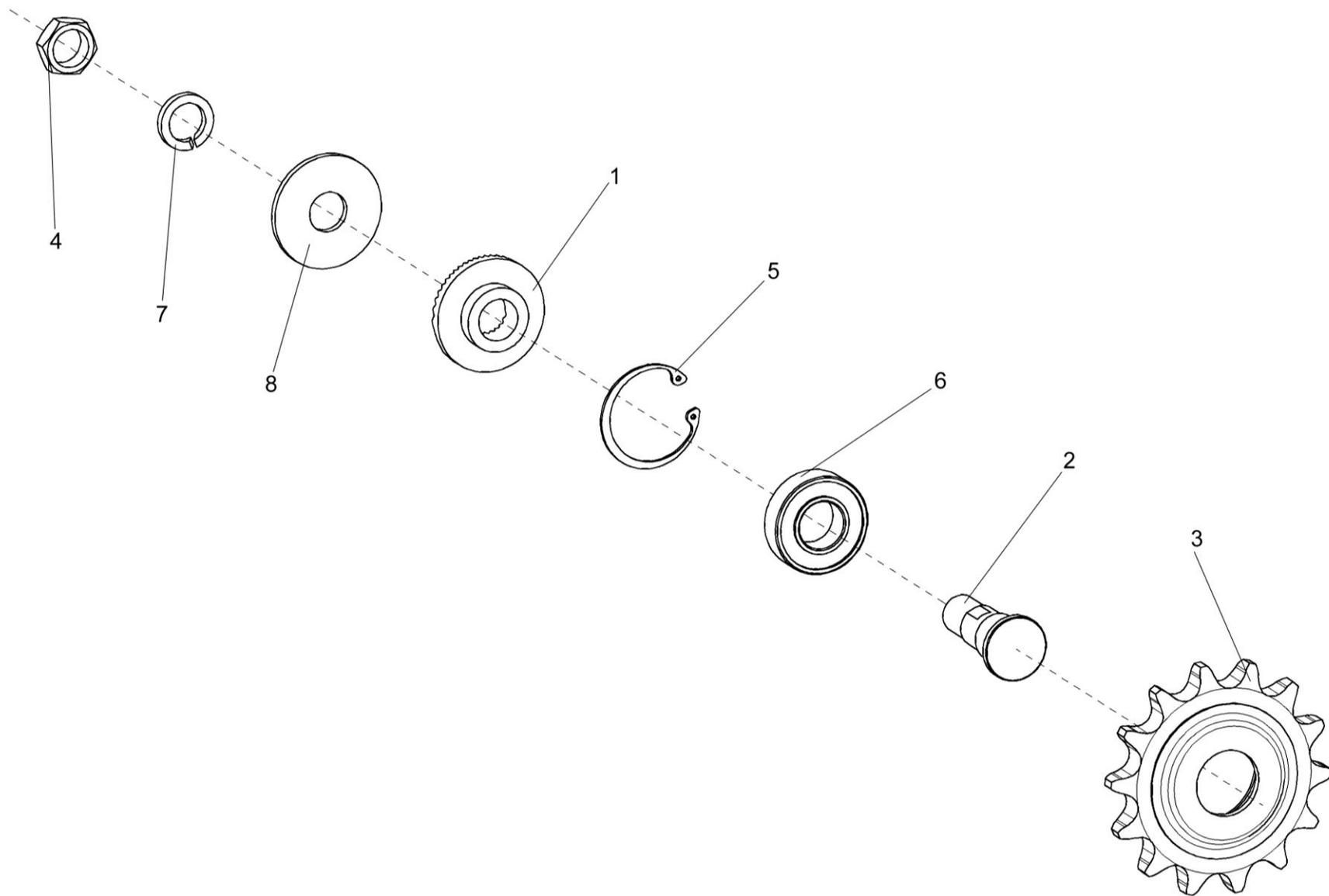
Рисунок 5 – Устройство натяжное КИС 0214000В
