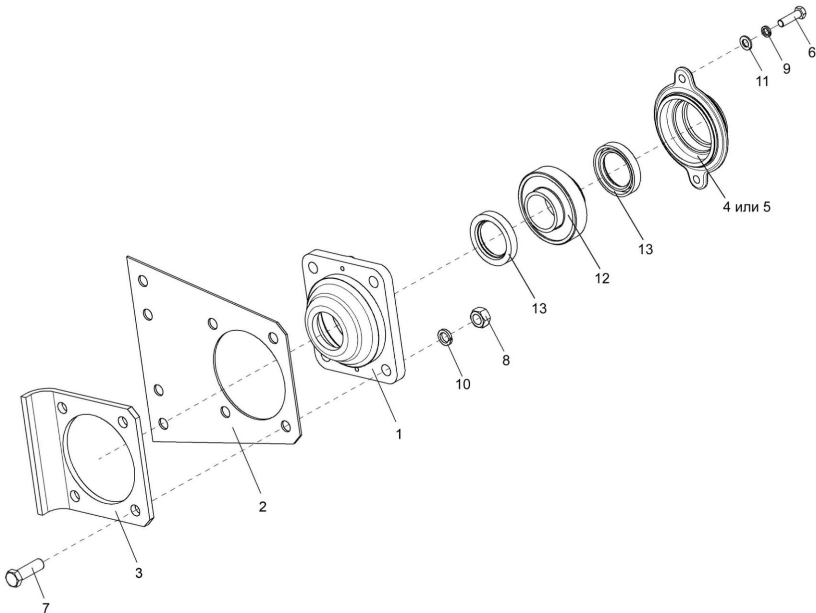
Рисунок 22 – Опора промежуточная КИС 0216040Б
