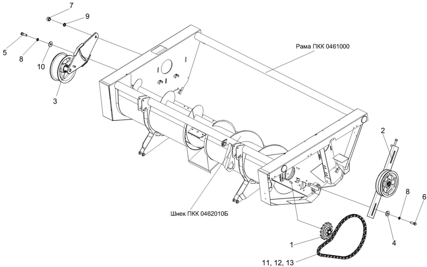
Рисунок 24 – Установка устройств натяжных КИС 0214000В, КИС 0215000Б и МКС 0533000
